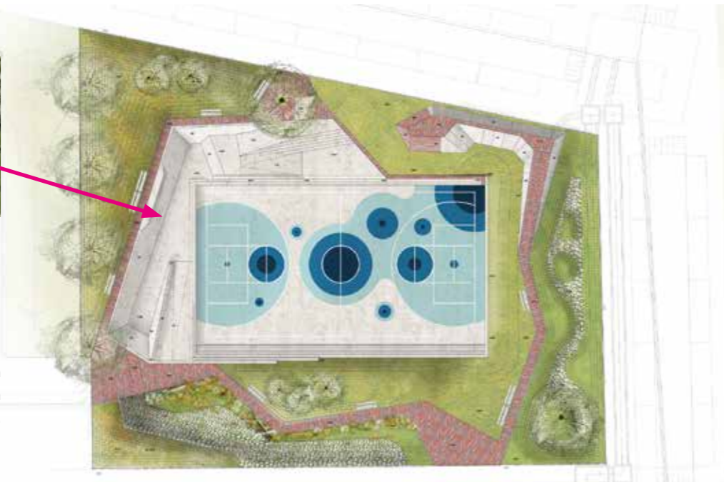
De slang van rode baksteen volgt een pad door een groen landschap en langs vier bassins voor wateropvang.
